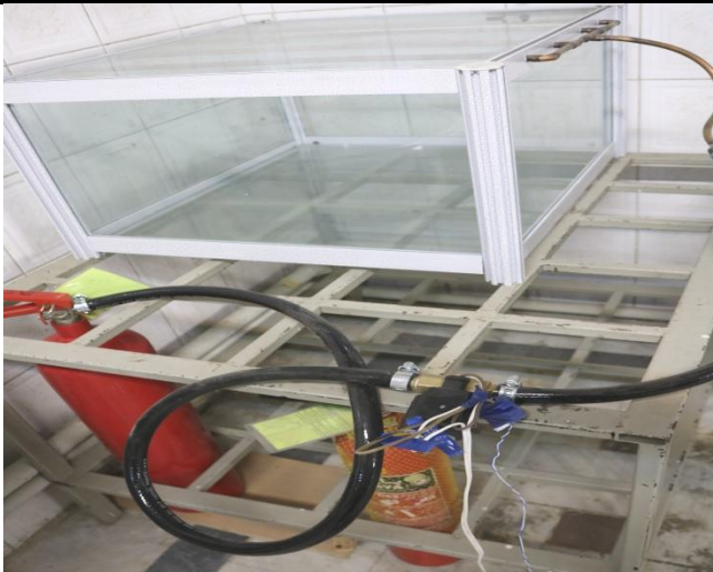
سیستم اطفاء حریق مبتنی بر CO 2
